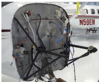
איור 4. - מנשא מנוע אופקי. מימין מבנה ומשמאל מנשא מורכב על קיר האש
