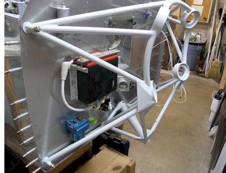
איור ה.5 - מנשא מנוע אנכי. מימין - מנשא בעל תמיכה קונית ומשמאל מנשא בעל תמיכה מקבילית
