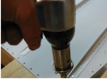
איור ד.5 - Back Riveting. מימין לוחץ המסמרות האחורי ומשמאל טכניקת העבודה
