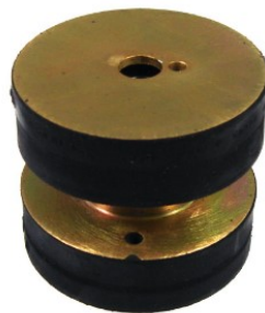
איור ה.6 - בולם זעזועים מגומי. דסקיות המתכת משני הצדדים "מפזרות את הלחץ" ע"פ כל שטח הגומייה
