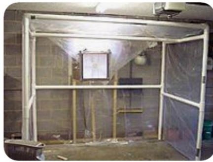
איור ד.10 - סוכות צביעה. מימין סוכה מצינורות וניילונים ומשמאל סוכת צביעה קשיחה
