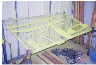
איור ד.11 - מתקני צביעה. מימין, שולחן צביעה ומשמאל, מתקן לצביעת חלקים קטנים וארוכים
