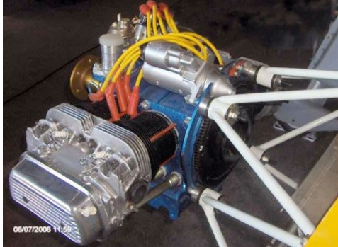
איור ה.5 - מנשא מנוע אנכי. מימין - מנשא בעל תמיכה קונית ומשמאל מנשא בעל תמיכה מקבילית
