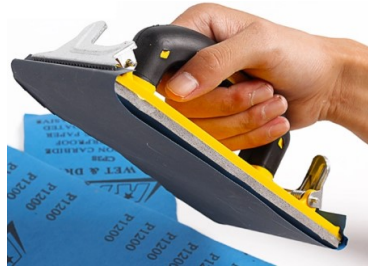
איור ב.12 - הצמדת נייר ליטוש למשטח ישר לקבלת שטח מעובד ישר ואחיד
