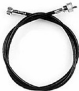
איור ט'-2 - מד סיבובים מכאני והצינור הגמיש המחבר בינו לבין המנוע
