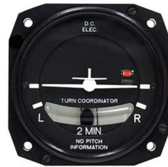
איור ט'-15 - מד פניה והחלקה. מימין - תצוגה משמאל - מבנה פנימי
