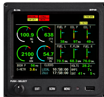
איור ט'-5 - EFIS - צג נתוני מנוע ומערכת איסוף נתוני המנוע
