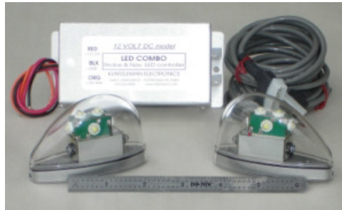
איור ד'-15 - מערכת תאורת מניעת התנגשות מבוססת לדים והכוללת ספק ייעודי
