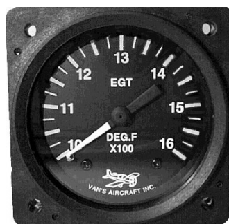
איור ט'- 4 - מד טמפ. ראש צילינדר, מד טמפ. גזי הפליטה וגוש משדר טמפ. גזי פליטה
