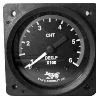
איור ט'- 4 - מד טמפ. ראש צילינדר, מד טמפ. גזי הפליטה וגוש משדר טמפ. גזי פליטה
