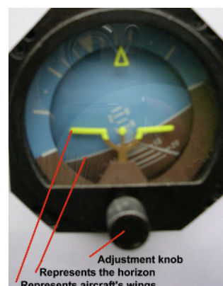
איור ט'- 14 - אופק מלאכותי. מימין - תצוגה משמאל - מבנה פנימי
