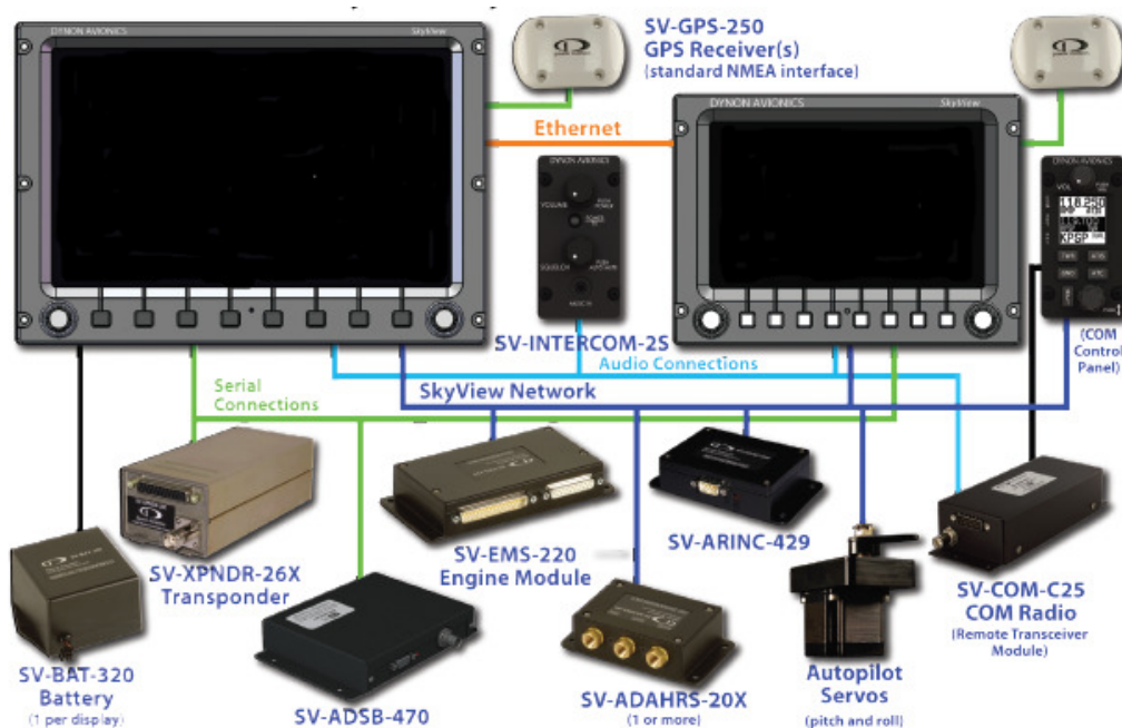
איור ט'-24 - מערכת EFIS שלימה במחברת באמצעות תקשורת טורית
