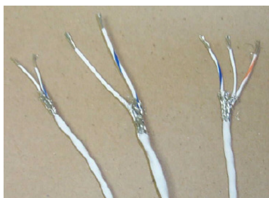
איור י' - 14 חוטים מסוככים. מימין, חוט סיכוך עם שלושה מוליכים פנימיים. במרכז ובשמאל חוט סיכוך עם שני מוליכים
