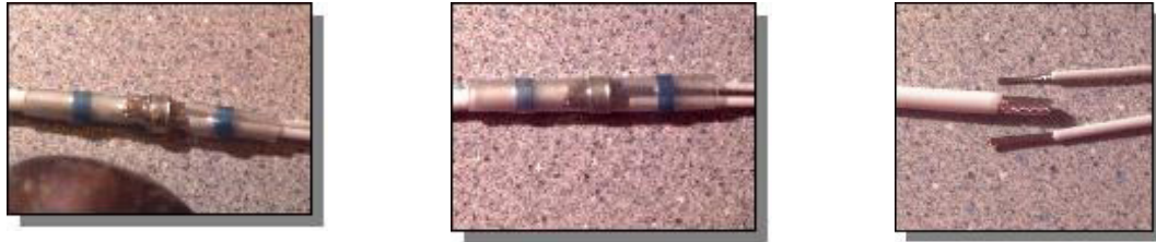
איור ה'-6 - א. חשיפת קצוות החוטים. ב. השחלת החוטים למחבר ההלחמה. ג. חימום עד להתכה של הבדיל
