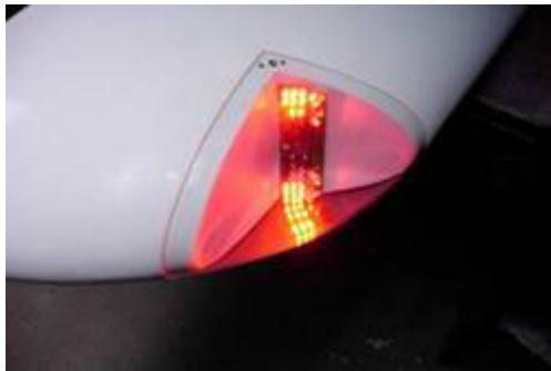
איור ד'-11 - אור נחיתה ואורות ניווט מתחת לחיפוי אווירודינאמי שקוף בקצה כנף
