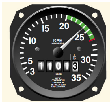
איור ט'-2 - מד סיבובים מכאני והצינור הגמיש המחבר בינו לבין המנוע
