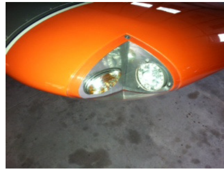
איור ד'-11 - אור נחיתה ואורות ניווט מתחת לחיפוי אווירודינאמי שקוף בקצה כנף
